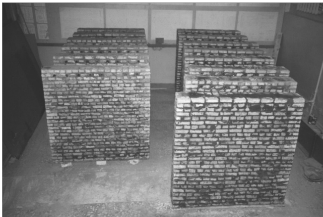
Рис. 1. Общий вид кирпичных и армокирпичных стен
