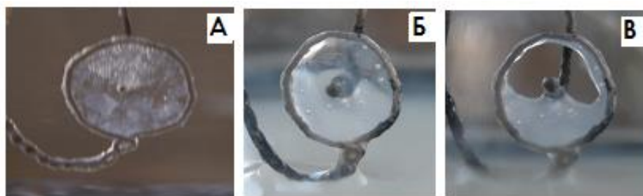
Рис. 3. Макроскопические пленки диаметром 4,5 мм: эмульсионная вода-в-декане (а) и пенная (б, в). Стабилизатор – аэросил, модифицированный гексиламином.
