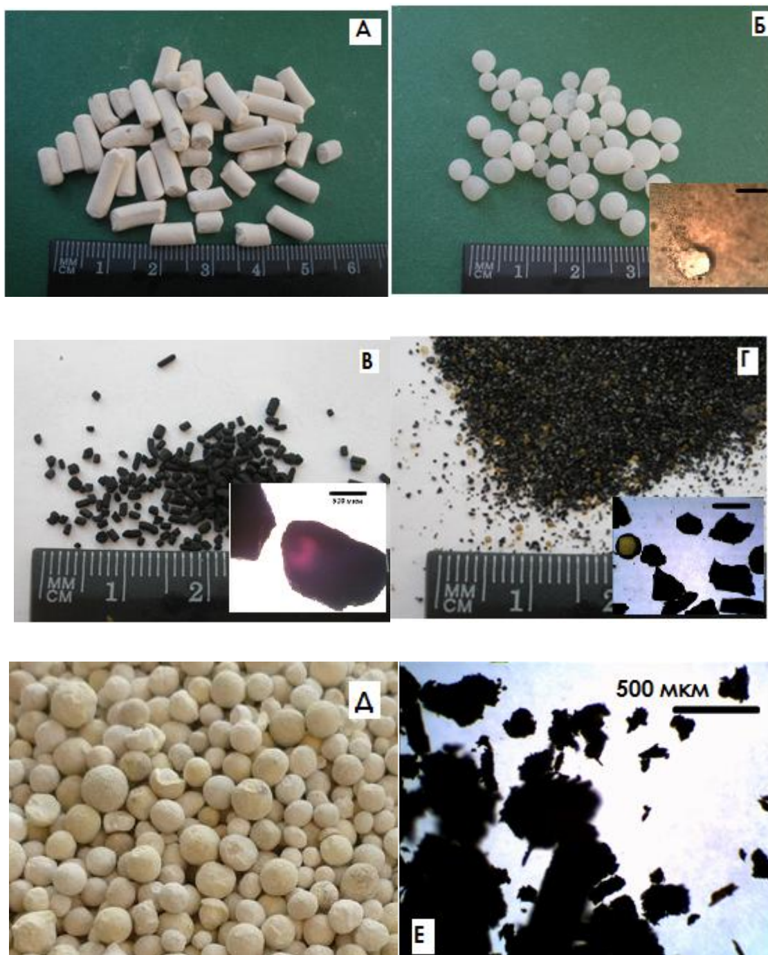
Рис. 1. Зерна адсорбентов: А) цеолит; Б) силикагель; В) активированный уголь; Г) наполнитель «Аквафор»; Д) диатомит; Е) лигнин (при увеличении). На вставках – микрофотографии.
