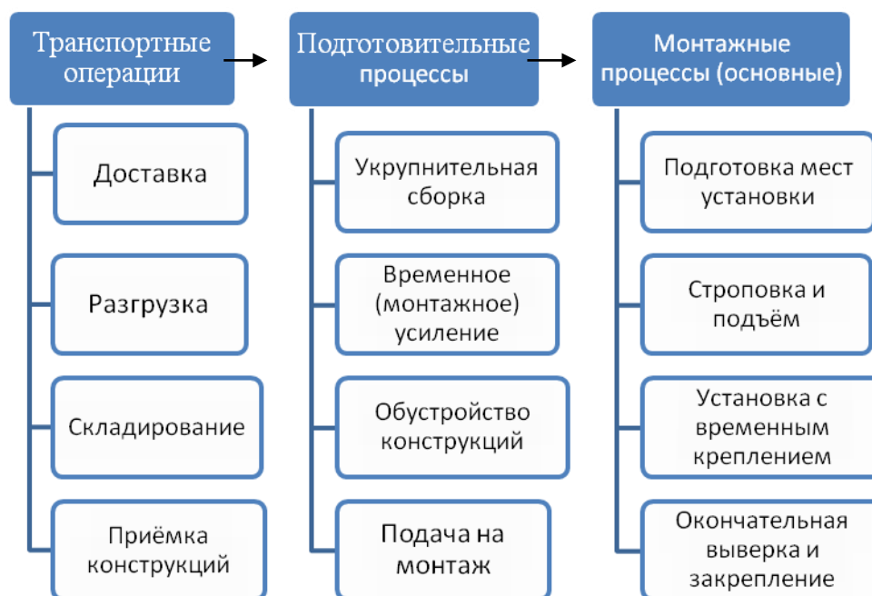
Рис. 4. Составляющие комплексного процесса монтажа
