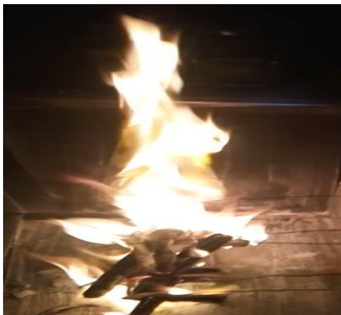
Рис. 1. Горение модельного очага пожара класса А
