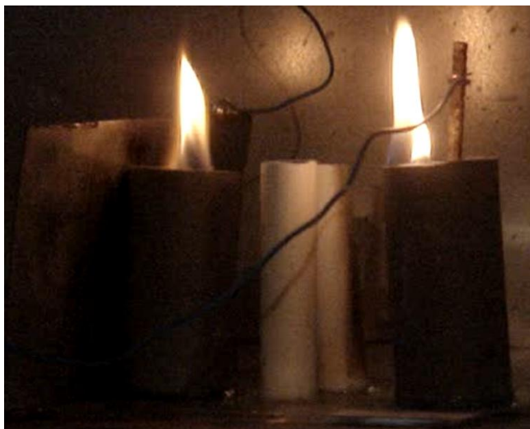
Рис. 4. Горение модельного очага пожара класса В
