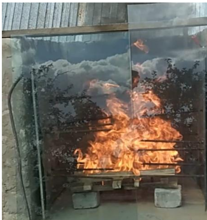
Рис. 8. Горение модельного очага пожара класса А
