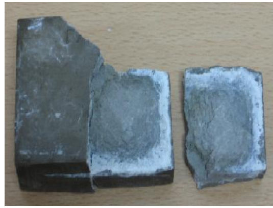
Рис. 2. Саморазрушение образцов при нахождении их в воде:
