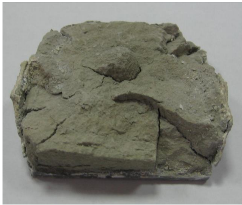
Рис. 2. Саморазрушение образцов при нахождении их в воде:
