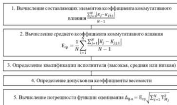
Рис. 3. Алгоритм расчета погрешности функции оценивания
