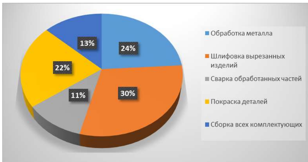
Рис. 2. Процентное соотношение несоответствий на каждом этапе производства сеялки С-6ПС (в расчёте от общего количества дефектной продукции)
