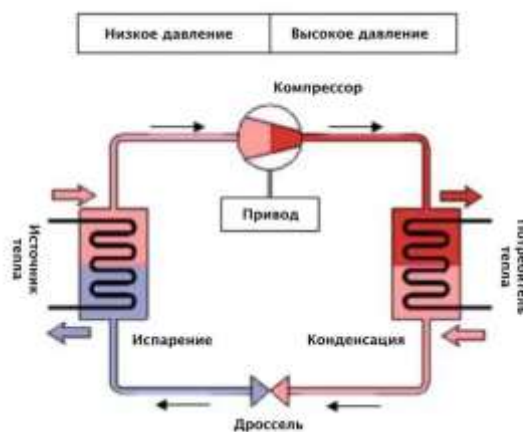
Рис. 1. Схема работы теплового насоса
