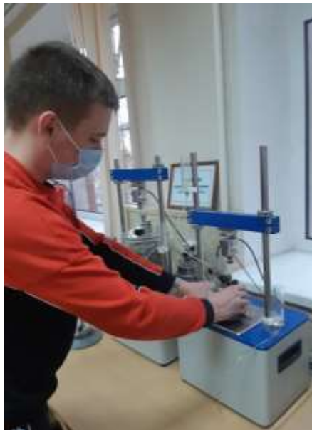
Рис. 1. Подготовка компрессионного одометра к испытанию
