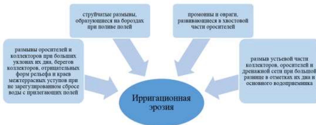
Рис. 2. Процессы, приводящие к ирригационной эрозии
