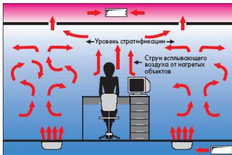
Рис. 2. Схема вытесняющей вентиляции в офисных помещениях
