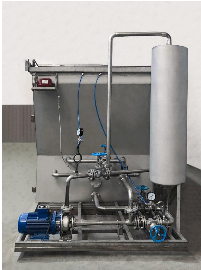
Рис. 2. Общий вид напорной флотационной установки
