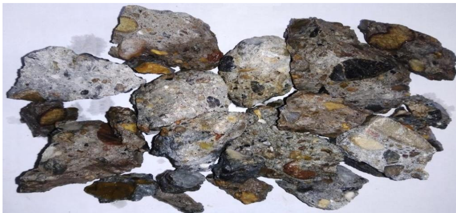
Рис. 2. Конгломератная структура зерен вторичного щебня фр. 5-40 мм
