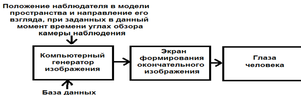
Рис. 3. Схема обработки информации в имитаторе тепловизора
