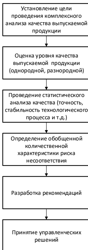
Рис. 1. Алгоритм комплексного анализа качества производственного процесса
