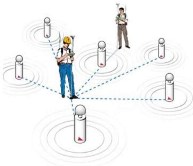
Рис. 1. Принцип выполнения измерений относительно референционных станций
