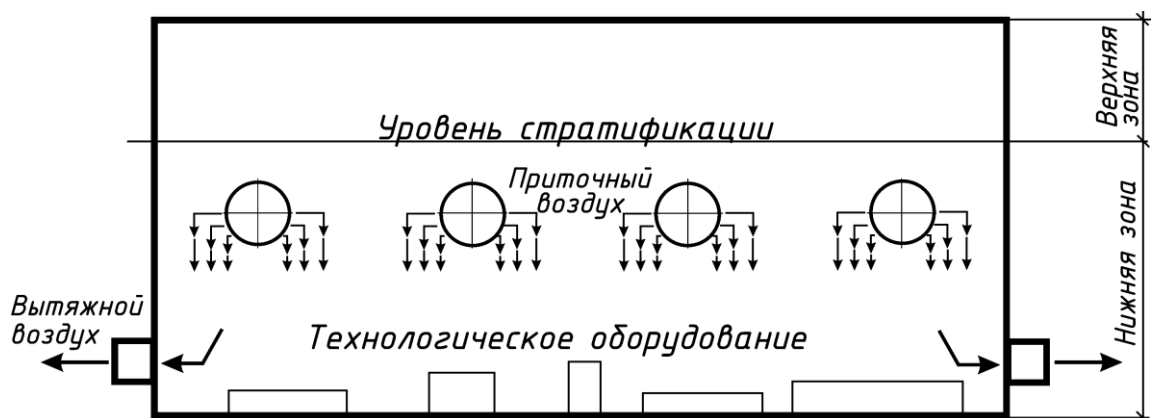
Рис. 4. Активная термовытесняющая вентиляция с воздухообменом «сверху вниз»
