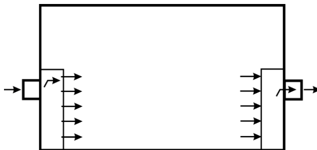
Рис. 1. Система вытесняющей вентиляции: а – вертикальная однонаправленная с воздухообменом «снизу вверх»; б – вертикальная однонаправленная с воздухообменом «сверху вниз»; в – горизонтальная однонаправленная с воздухообменом «снизу вниз»
