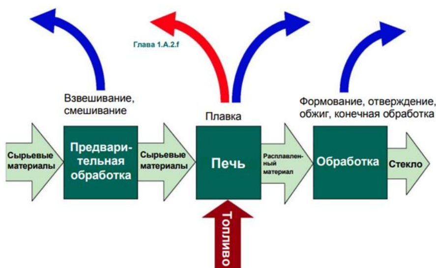
Рисунок 3 – Базовая технологическая схема производства стекла.
