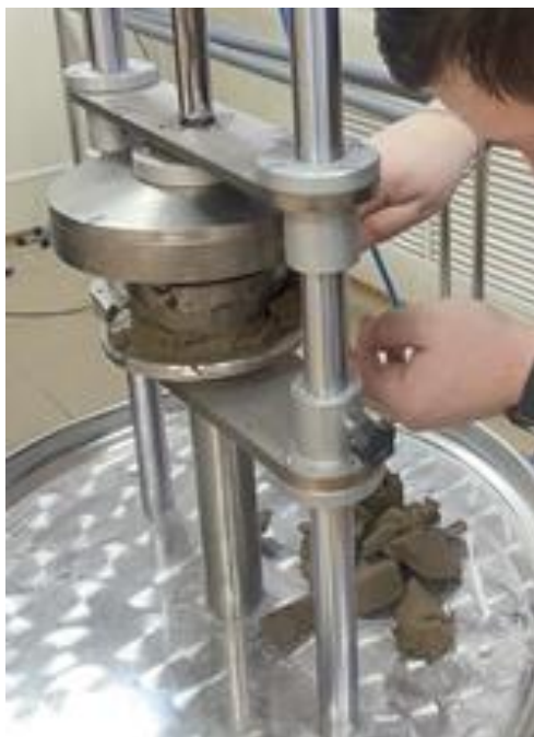
Рис. 1. Подготовка образцов грунта методом режущего кольца:
