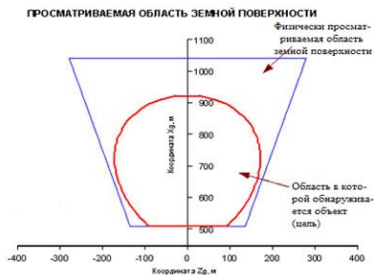
Рис. 4. Область обнаружения объекта с помощью ЛД
