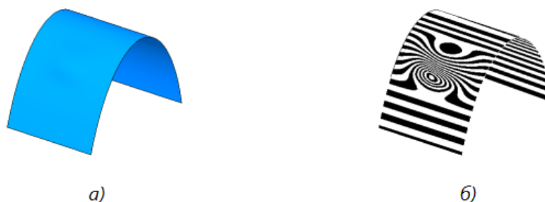
Рис. 8. Проверка гладкости поверхности (поверхность имеет небольшую выпуклость): а – полутонное с каркасом отображение модели – выпуклость практически не видна; б – режим проверки гладкости модели (способ Зебра) – выпуклость хорошо видна
