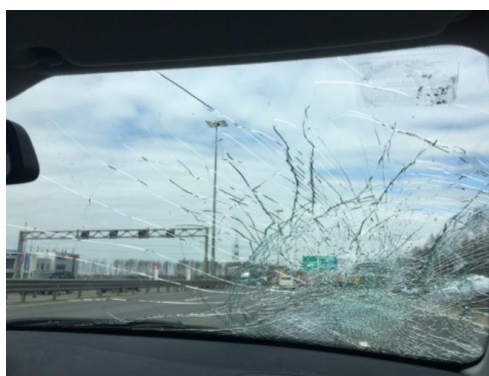
Рис. 2. Повреждение автомобиля упавшим куском льда на Большом Обуховском мосту в г. Санкт-Петербург
