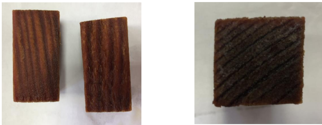
Фото 1. Структура древесины сосны после щёлочно-сульфитной варки
