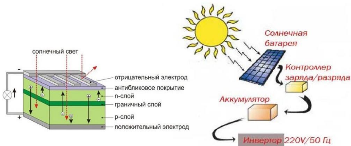
Рис. 2. Схема работы солнечных батарей
