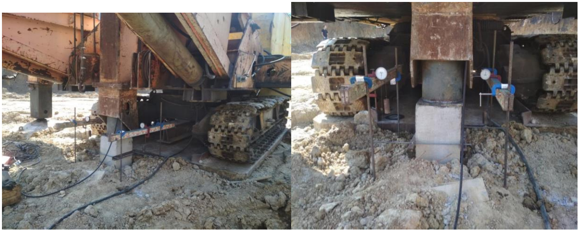
Рис. 6. а) общий вид испытательного стенда; б) установка гидравлического домкрата и реперной системы
