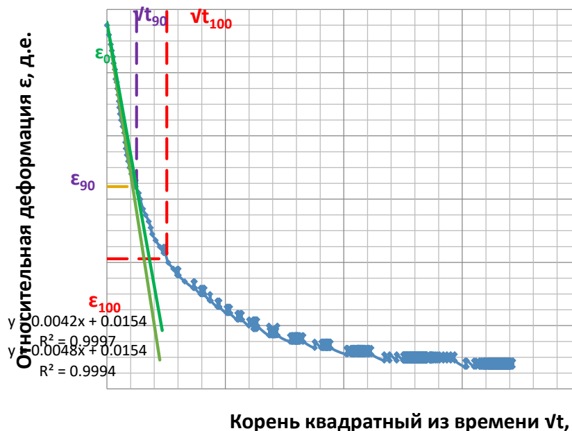
Рис. 1. Зависимость относительной деформации от корня квадратного из времени при заданном напряжении \epsilon = f(\sqrt{t})
