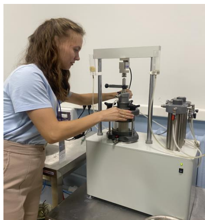
Рис. 2. K_0 испытание дисперсного грунта в камере типа Б.
