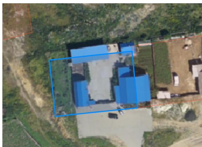
Рис. 2. Пример результата проверки точности геодезических измерений, выполненных в рамках комплексных кадастровых работ в квартале 58:14:0360201 (кадастровый номер земельного участка 58:14:0360201:28)
