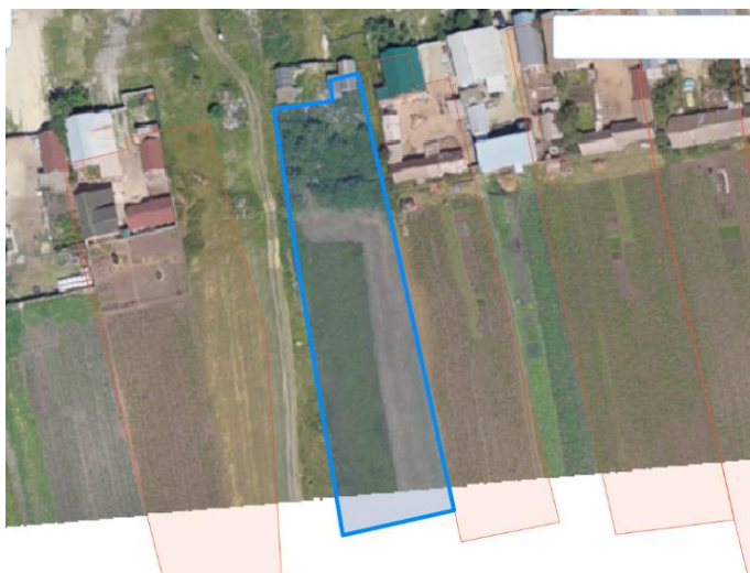
Рис. 3. Пример результата проверки точности геодезических измерений, выполненных в рамках комплексных кадастровых работ в квартале 58:14:0360201 (кадастровый номер земельного участка 58:14:0360201:143)
