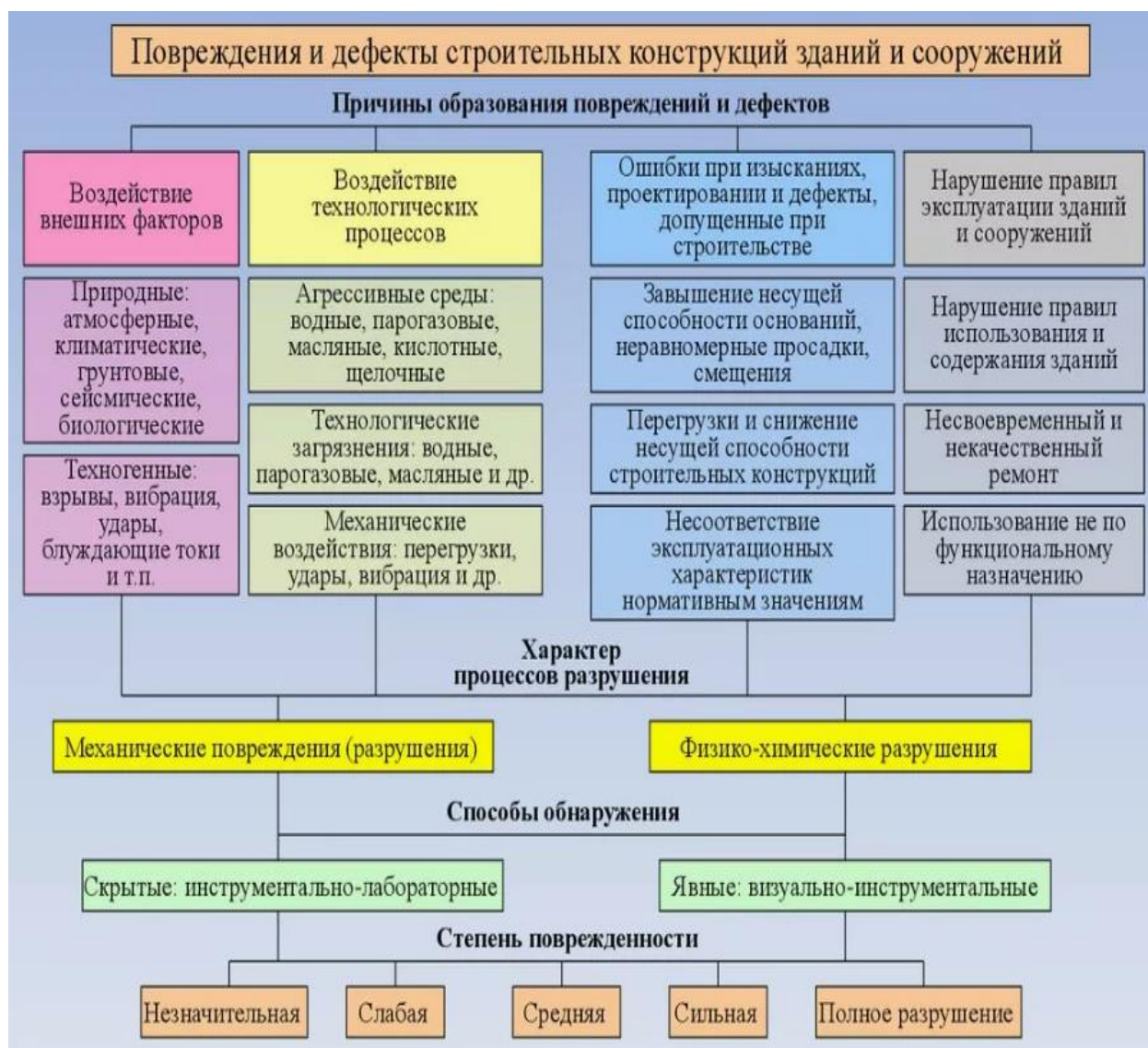
Рис. 1. Типичные повреждения строений
