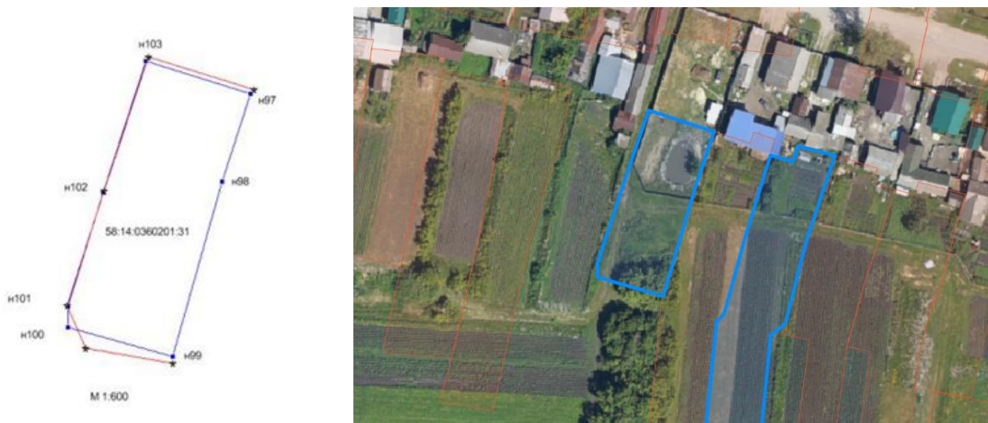
Рис. 1. Пример результата проверки точности геодезических измерений, выполненных в рамках комплексных кадастровых работ в квартале 58:14:0360201 (кадастровый номер земельного участка 58:14:0360201:31)
