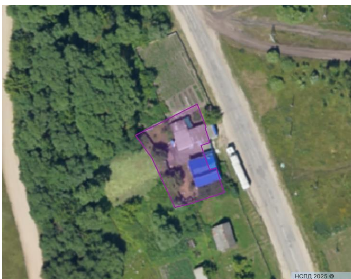
Рис. 4. Пример результата проверки точности геодезических измерений, выполненных в рамках комплексных кадастровых работ в квартале 58:14:0450201 (кадастровый номер земельного участка 58:14: 0450101:30)
