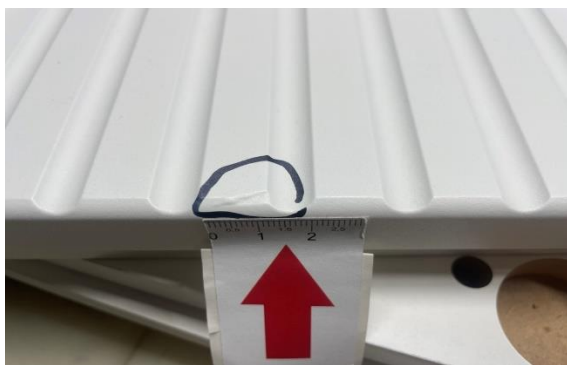
а) сколы после фрезеровочного станка
