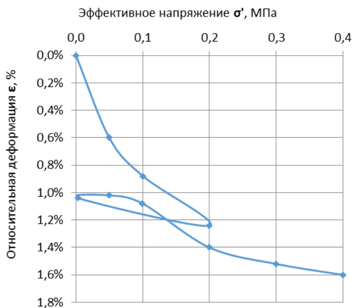
Рис. 1. Зависимость между относительной вертикальной деформацией и эффективными напряжениями в грунте при компрессионном сжатии
